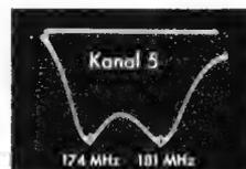
b) Kanal 5 nach Abgleich der beiden Trimmer C 5, C 8
