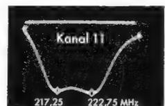
c) Kanal 11 nach Abgleich der beiden Luftspulen durch Zusammen-drücken oder Auseinanderziehen der Windungen
