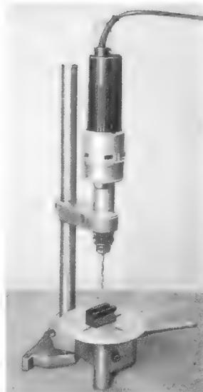
Bild 5. Alle Teile des Bohrständers sind schon bei der Drehbank vorhanden
